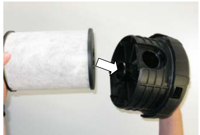
Fig. 24 Mise en place du séparateur d'huile, ProVent 800
