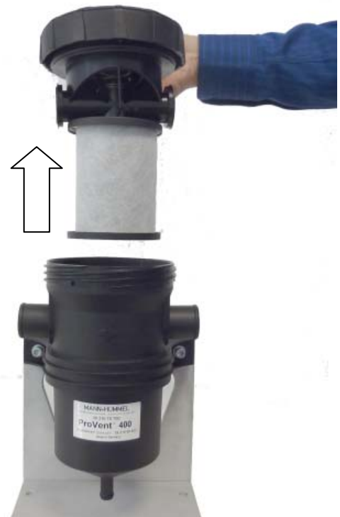
Fig. 18 Enlèvement du séparateur d'huile, ProVent 400
